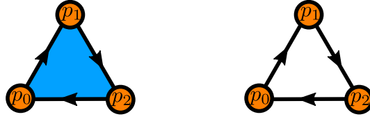
FIGURE 1.8 – À gauche, le 2-simplexe (p_0p_1p_2) et, à droite, sa frontière donnée par \partial_2(p_0p_1p_2) = (p_1p_2) + (p_0p_2) + (p_0p_1) .
